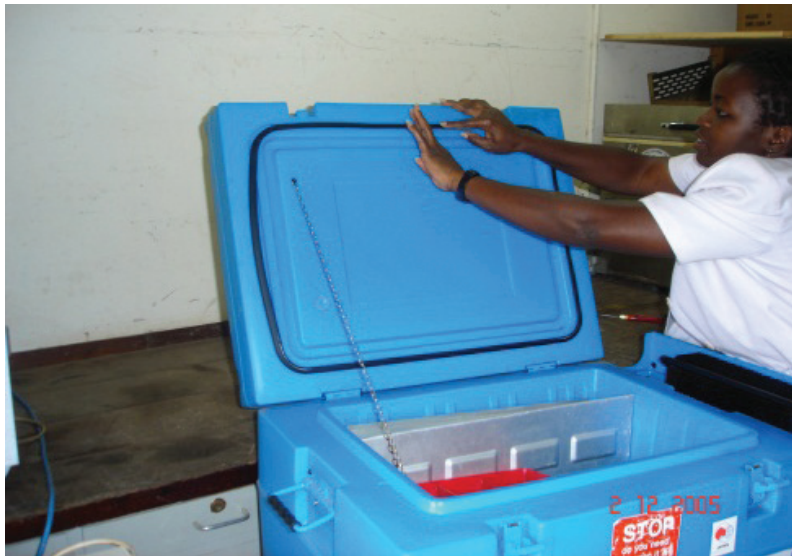
Fig. 4.25 Replacing door gasket
