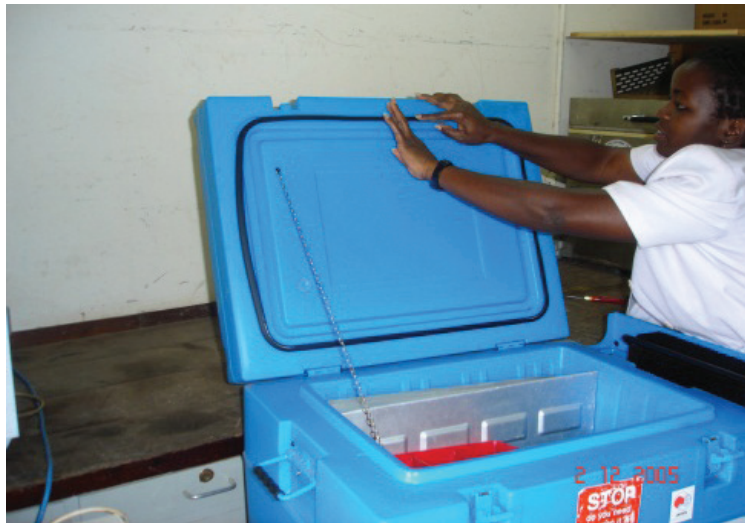
Fig. 4.25 Replacing door gasket
